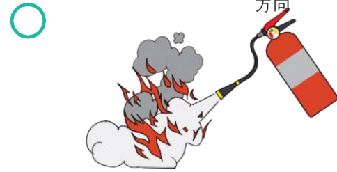
像用扫帚扫地一样，将灭火剂均匀地喷洒在着火处
