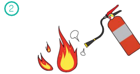
在室外使用时，要背对风向站立； 在室内使用时，要背对紧急出口站立，并将喷管朝向火源
